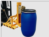
1DE-EP: 单桶夹，双鹰嘴设计，只能搬运1个高桶盖开口塑料桶。
