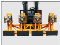
4DE: 四桶夹，一次可搬运一字排开的1到4个桶。（需配3吨及3吨以上叉车）
