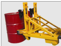
QL: 快锁装置，采用偏心轮设计，将桶夹快速锁紧在货叉上面，无需安全链。
