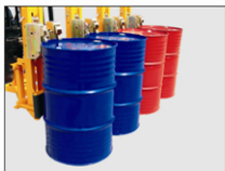
4DE: 四桶夹，一次可搬运一字排开的1到4个桶。（需配3吨及3吨以上叉车）
